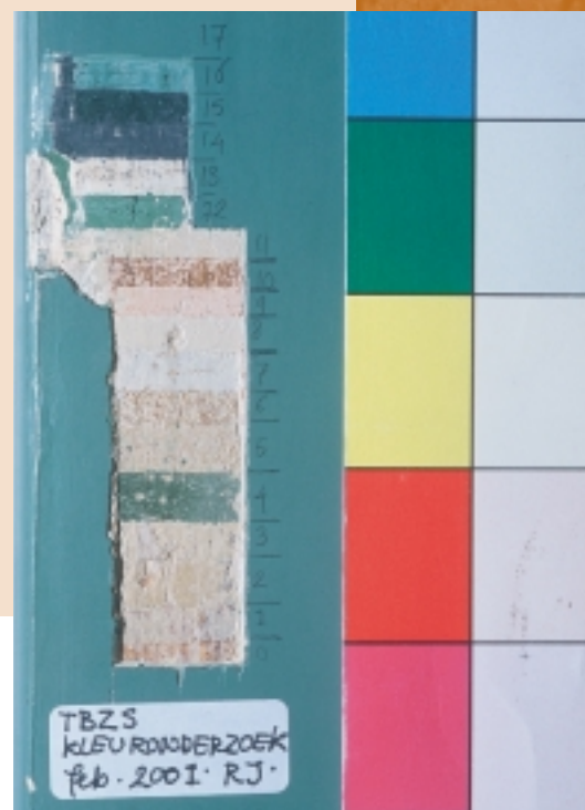
Bij kleurhistorisch onderzoek wordt in kleurentrappen de verf laag voor laag in vlakjes naast elkaar weggeschrapt, zodat er een chronologische reeks ontstaat. Hierdoor kan er een indicatie worden verkregen van de verflaagbouw (foto Ruth Jongma)
