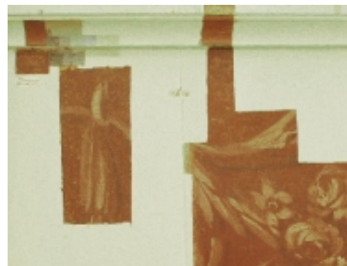
Kleuronderzoek in verschillende fasen: eerst een verkenning met puncties (boven), soms uitgewerkt tot een stratigrafie (midden). In een tweede onderzoeksfase (onder) zijn grotere kleurvlakken uitgelegd (foto's Ruth Jongsma)
