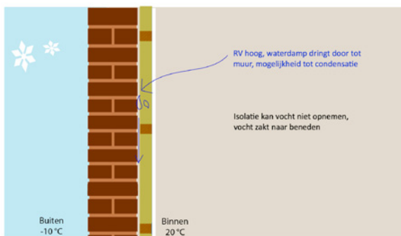
Afbeelding 5A-B Schematische weergave van dampopen isoleren
