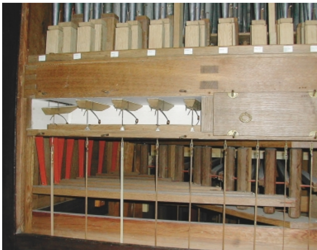
AFBEELDING 10 Een geopende ventielkast. Normaal is de ventielkast afgesloten met een voorslag, zoals rechts naast het geopende deel te zien is. De ventielen bevinden zich, naast elkaar, bovenin de ventielkast, tegen de onderzijde van het cancelraam. Het linkerventiel is geopend. Onder de ventielkast zijn de dumme abstracten te zien waarmee toetsen en ventielen aan elkaar verbonden zijn (foto Wim Diepenhorst)
