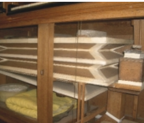
AFBEELDING 9 Een balg in geopende toestand. De vouwen van de balg zijn met leer aan elkaar verbonden. Onder de rechthoekige balg bevindt zich een schuine schepbalg, waarmee de bovenliggende balg gevuld wordt. Rechts naast de balg is een deel van het windkanaal te zien, waarmee de wind naar de windlade getransporteerd wordt (foto Wim Diepenhorst)
