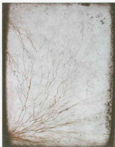
Schade door onjuist aangebrachte bescherming: twee plaatjes glas in één loodspinning met schimmel tussen het glas tot gevolg. Ook hier leidt de beschermende maatregel tot ernstige chemische aantasting (Foto R. Crèvecoeur)
