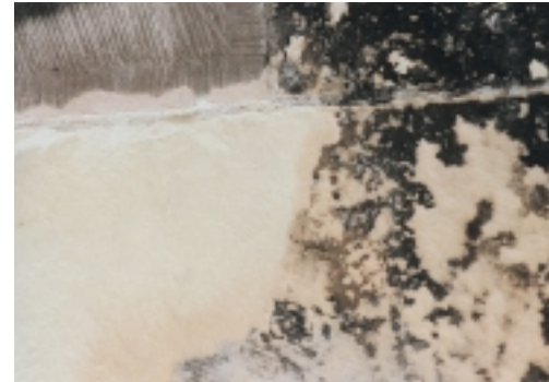
Blonde zandsteen verkleurt rood-roze nadat het sterk verhit is
