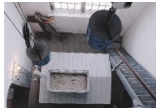
Noodzakelijke valkist onder de gewichten, gevuld met zand of (nog beter) met dakpannen om de val te breken
