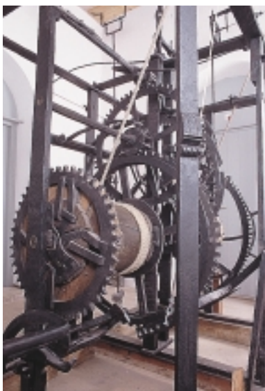
Zijaanzicht smeedijzeren uurwerk in de kerk te Winkel, Noord-Holland. Vooraan: het koord om de wals gewikkeld, waarmee het gewicht wordt opgetrokken
