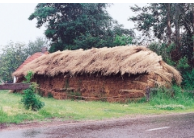
Voor langdurige opslag wordt het riet in een mijt opgeslagen, zodanig dat het riet naar één zijde afwatert
